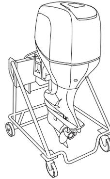
Trasportare e immagazzinare il motore in posizione verticale, come mostrato in figura. Attaccare la staffa porta-motore al supporto e fissare il motore con bulloni e dadi. Riporre il motore fuoribordo in una zona ben aerata, al riparo dei raggi solari e dell'umidità.
