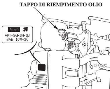
Drenare l'olio quando il motore è ancora caldo per assicurare uno spurgo rapido e completo.
