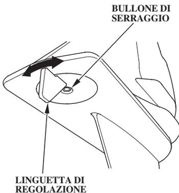
Se si tira da un lato il maniglione di governo/timone quando si procede alla massima velocità, regolare la linguetta in modo che l'imbarcazione proceda diritta.
