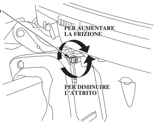
Nel trainare o trasportare l'imbarcazione con il motore installato, si raccomanda di lasciare il motore nella normale posizione di funzionamento, con il bullone attrito di governo ben serrato.
