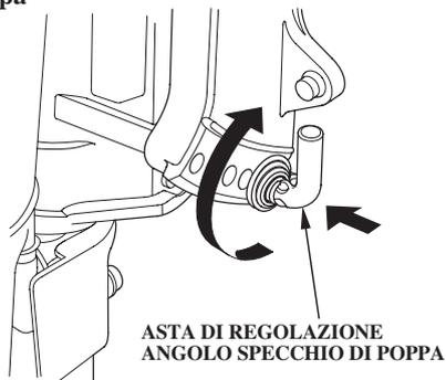
Utilizzare l'asta di regolazione dell'angolo specchio di poppa per regolare correttamente l'angolo motore.
